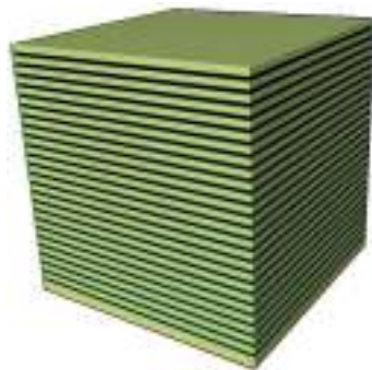
Рисунок 3.15 – Трёхмерная модель породы с тонкими горизонтальными слоями
