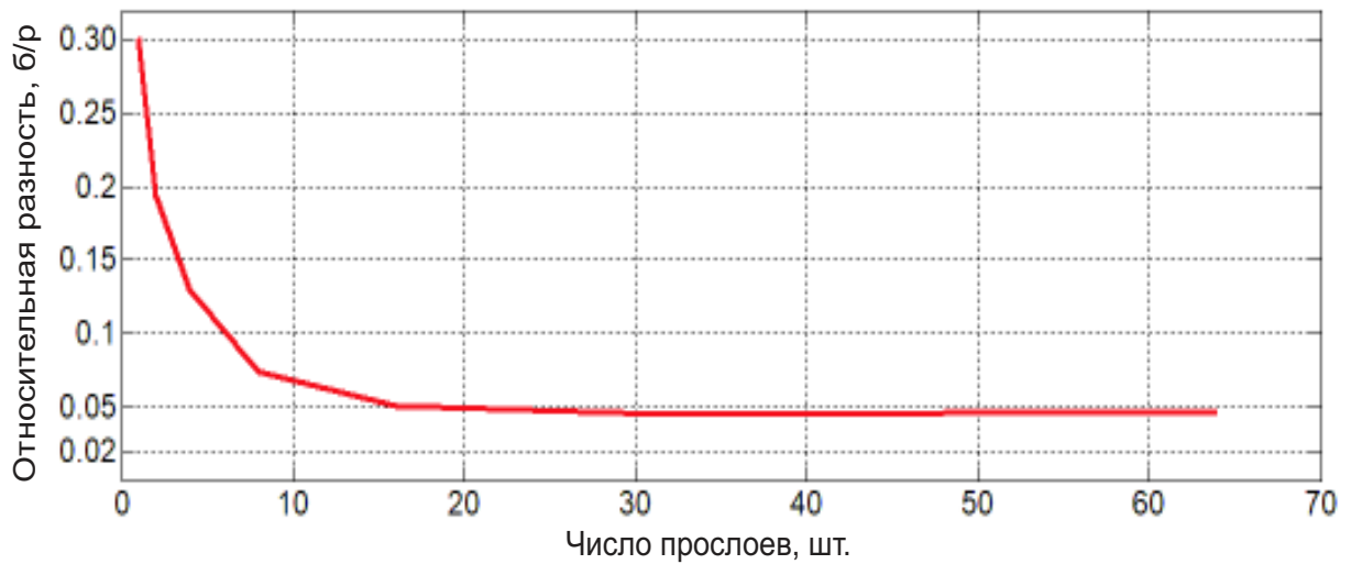
Рисунок 3.20 – Уменьшение относительной разности значений эффективного тензора жёсткости при увеличении количества прослоев в трёхмерной модели породы с двумя наклонами слоёв под углом 45^\circ
